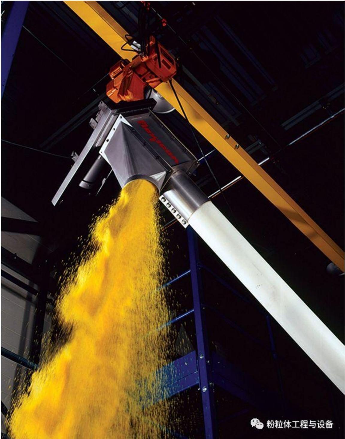
柔性螺钉穿过充电适配器槽，将一部分螺钉暴露于从上方流入槽中的材料。当旋转时，螺钉的暴露部分将材料送入外管，然后通过螺钉的封闭部分将材料推进管外。
