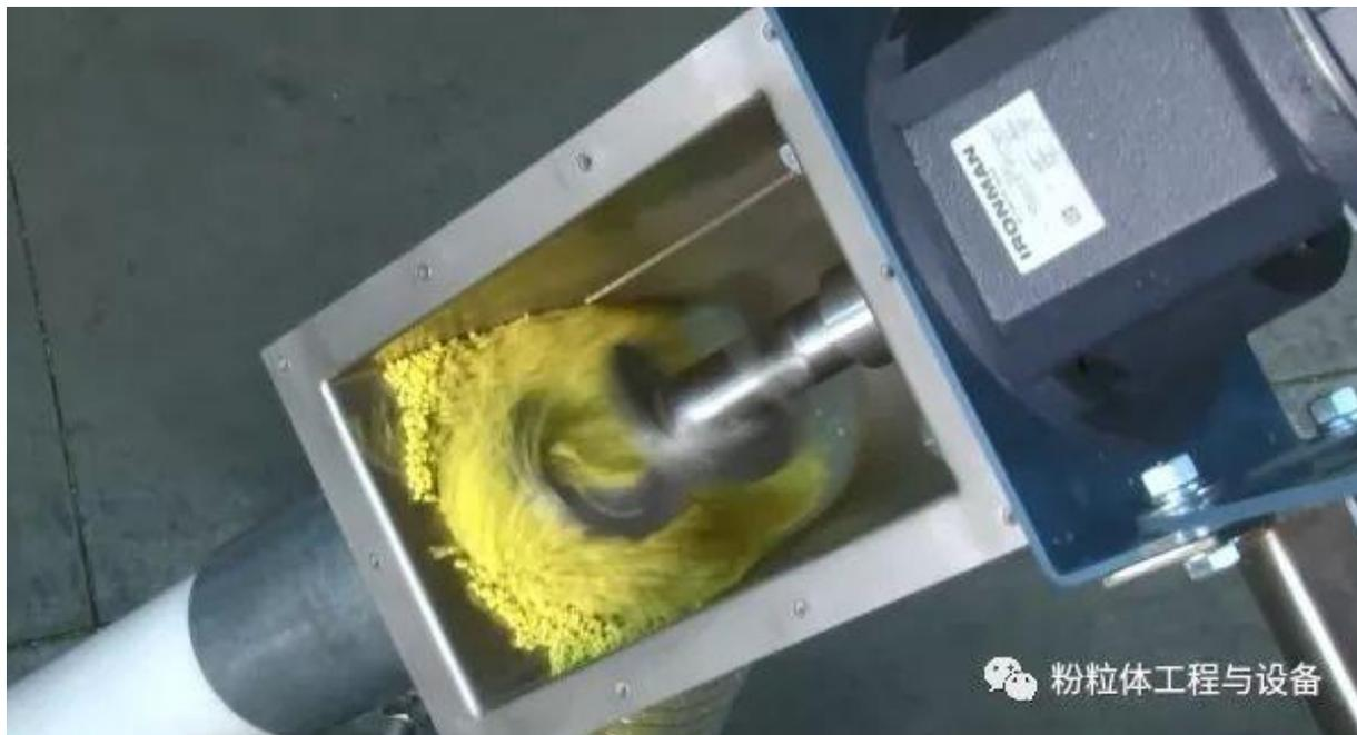
由旋转的柔性螺钉松散地装配在填充有散装材料的管内的现象是螺钉自动地在管内自对中，在螺钉和管壁之间提供间隙。这为颗粒提供了足够的空间而不会损坏，这取决于被输送的颗粒的脆弱性和尺寸。
