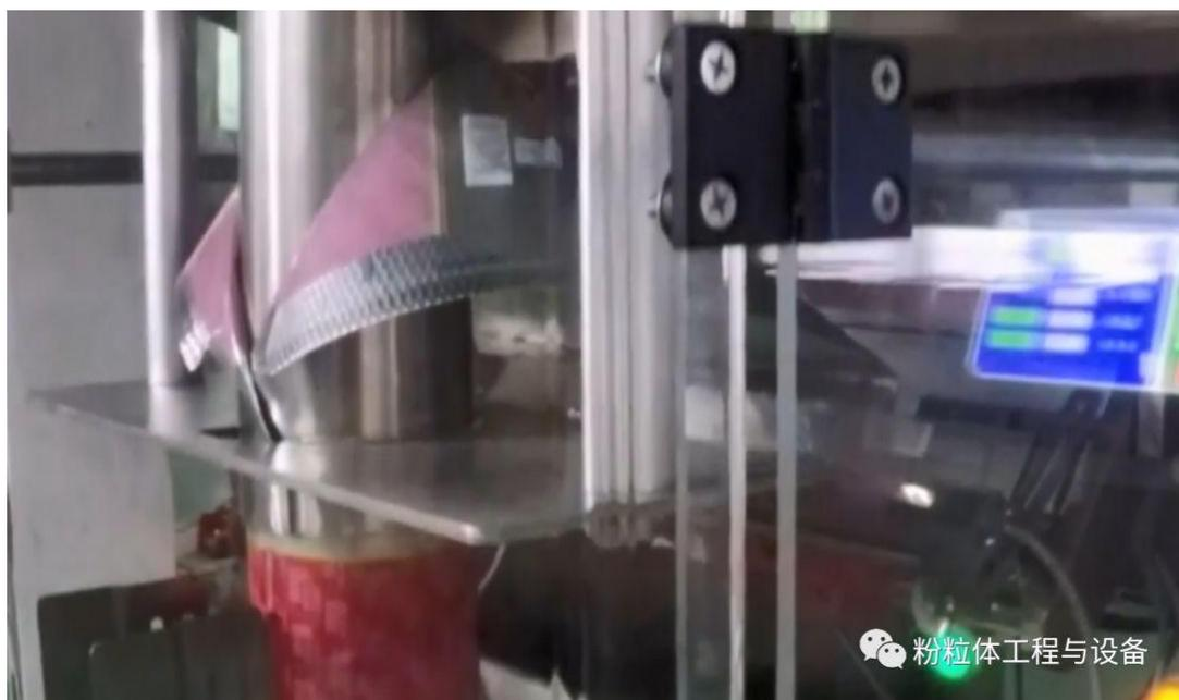
灌装量少步调整：同轴光电编码，采用微电脑控制，实现额定范围内的步进调整。
