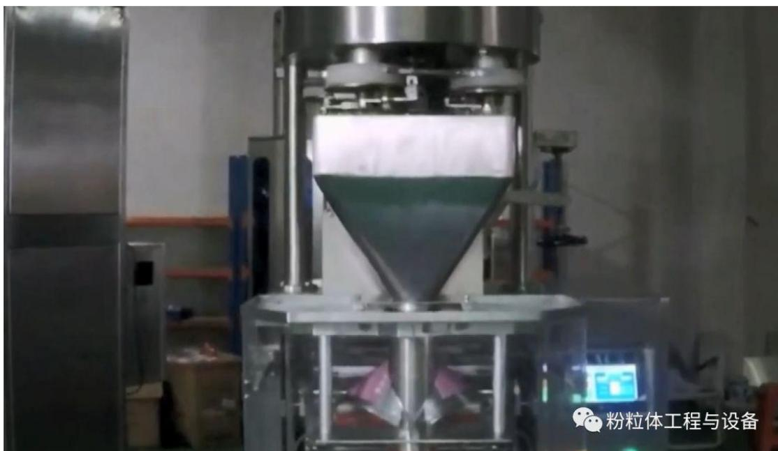
本机包装大袋用于颗粒型，YX-500 是一种大型，立式，三面封口，枕形袋，间歇式包装机。可自动完成制袋，计量，灌装，封口，切割，计数，批号印刷等工序。
