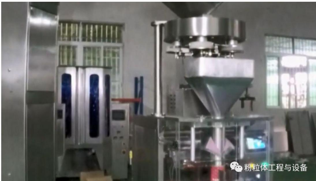
热封双温控制：温度由智能温度控制器提前设定，温度控制准确，适用于各种包装材料，良好的热平衡，保证密封质量。
