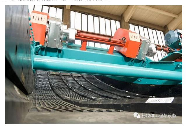
Schenck Process LinaClass 系列直线运动振动筛用于筛选高达 3,000 t / h 的产品流量和最大 400 mm 的粒度。切割点可设置为 100mm。其坚固的设计确保了高度的操作可靠性和可用性,即使在恶劣的条件下也是如此。
